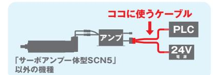
可動用シリアル通信用平行接続ケーブル《サーボアンプ一体型SCN5以外用》
